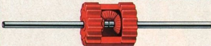
Schnitt durch das Differentialgetriebe Cross section through differential gear Coupe du différentiel Sezione dell'ingranaggio differenziale Doorsnede van differentieelaandrijving
